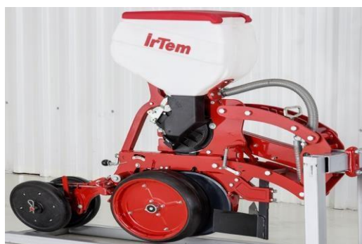
2. “Dupli disk” tip setvene jedinice
