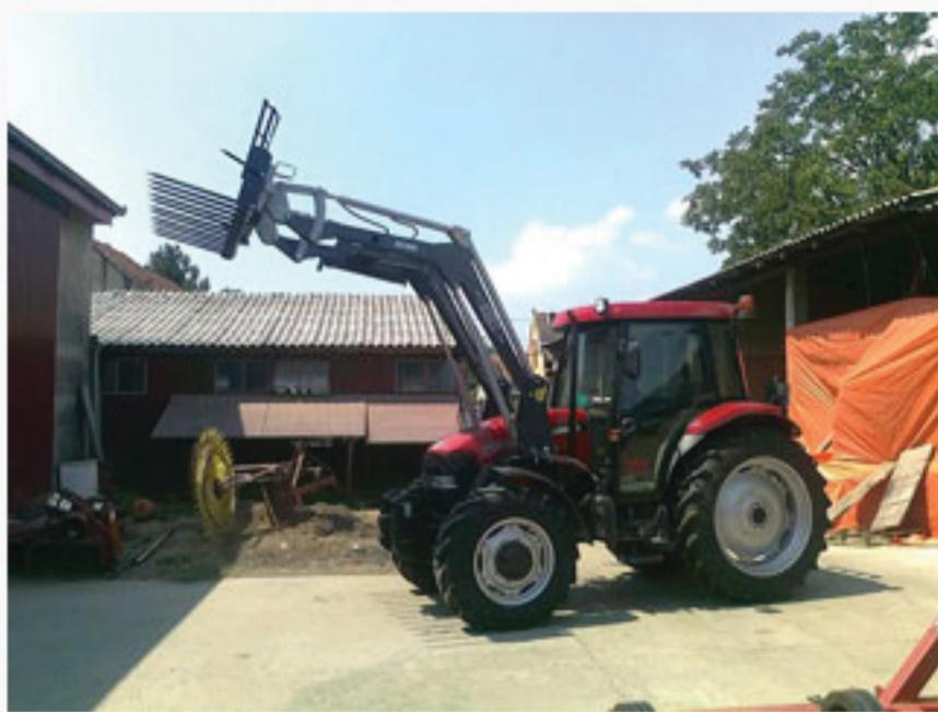
Hidraulični utovarivač (HUT) prevashodno je namenjen za utovar stajskog đubriva pa se često naziva i utovarivač stajnjaka. Za ovu svrhu se koriste izmenjivi nastavci u obliku vila. Međutim primenom nastvaka u obliku korpe omogućeno je manipulisanje rasutim materijalima (zemlja, pesak, šljunak, piljevina ...), a priključivanjem tzv. kašike omogućeno je i kopanje kanala.
